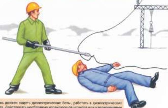
Спасатель должен надеть диэлектрические боты, работать в диэлектрических перчатках. Действовать необходимо изолирующей штангой или изолирующими клещами, рассчитанными на соответствующее напряжение. Остальные меры предосторожности те же, что и при низковольтной травме.
