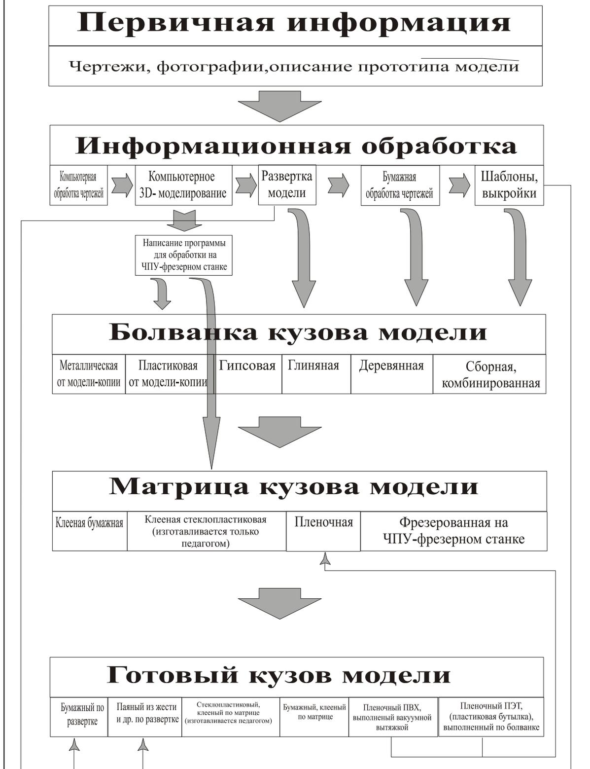
Рисунок 1. Алгоритм конструирования кузовов трассовых автомоделей
